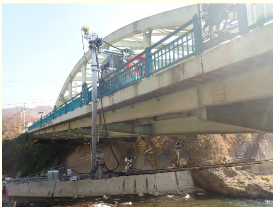
橋梁点検支援用ロボット
