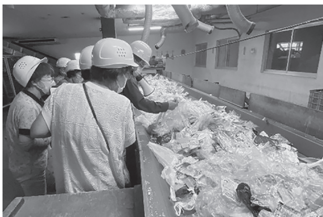
▲パレットの原料となる プラスチックの手選別ライン
