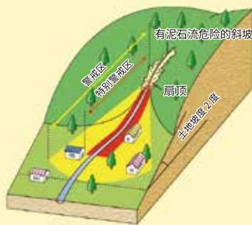
由于长时间降雨和集中暴雨等，山腰和溪流的石头和泥沙一下子被推到下游。以强大的威力和压倒性的速度，将前进方向上的东西一个接一个地吞噬并毁灭。
