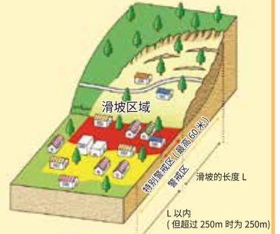
是在地质脆弱的土地上下暴雨，在变的松弛的一部分坡面，受地下水的影响和重力的作用下慢慢向下移动的现象。一旦发生就会对房屋、道路、铁路等造成大范围的损害。
