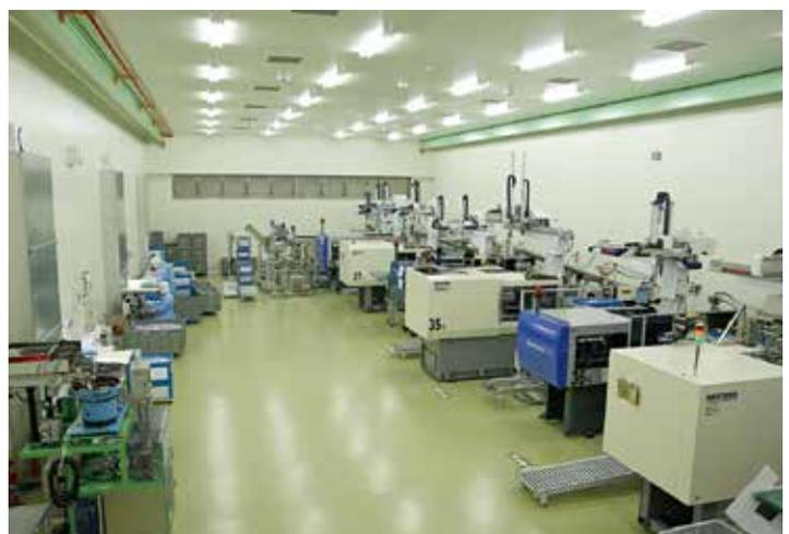
衛生面を徹底的に管理した大規模クリーンルーム。クラス10000において、医療、理化学、食品分野で使用するプラスチック成形品を生産する
