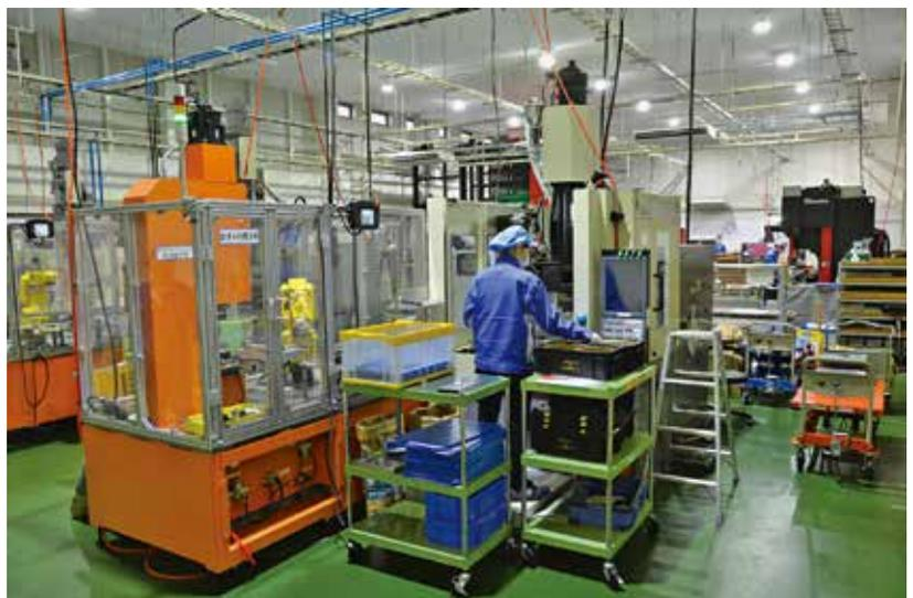
最新鋭のインサート成形技術でインバーター部品を生産する
