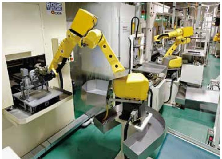
多関節ロボットを導入し、高精度、高効率、低コスト、省力化を追求する
