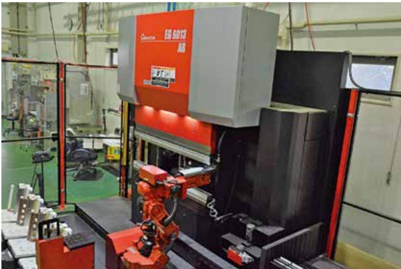
曲げ加工工程にはロボットが導入され、24時間の生産体制を整えている
