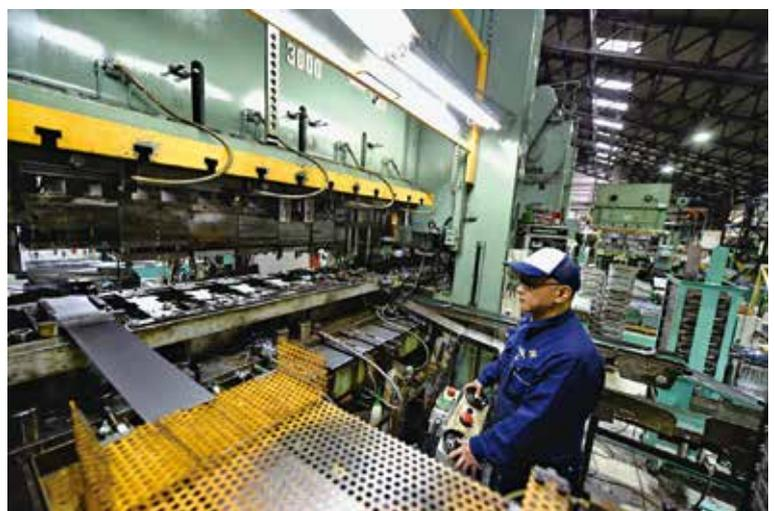
大型プレス機で金属板を打ち抜き、曲げ、絞っていく。技能、知識、根気がないと深絞り加工はできない
