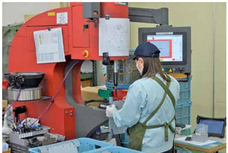
カシメ加工は薄い板ものの加工に適しているため、精密板金の分野で多く使われる
