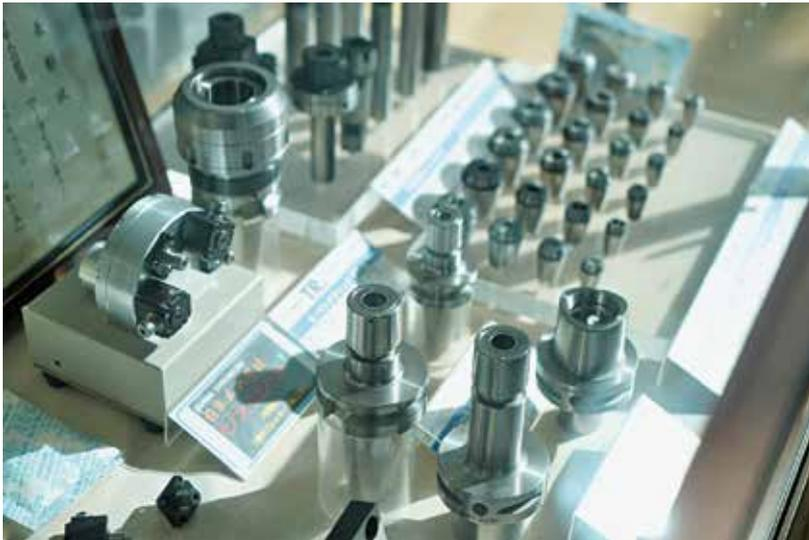
切削工具と工作機械をつなぐツーリング。加工精度を左右する基幹部品である
